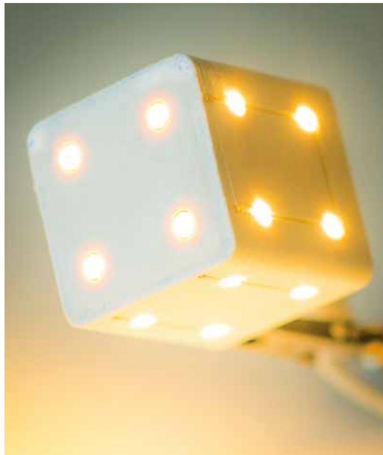
3D-gedruckte Antenne (Quelle: Neotech)
