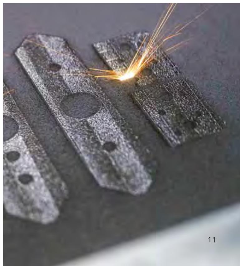
Belichtungsprozess beim Laserstrahlschmelzen (Quelle: Protiq)
