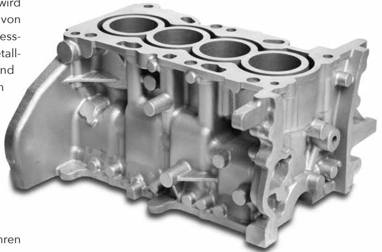
Additiv erzeugtes Ersatzteil für die Deutsche Bahn
