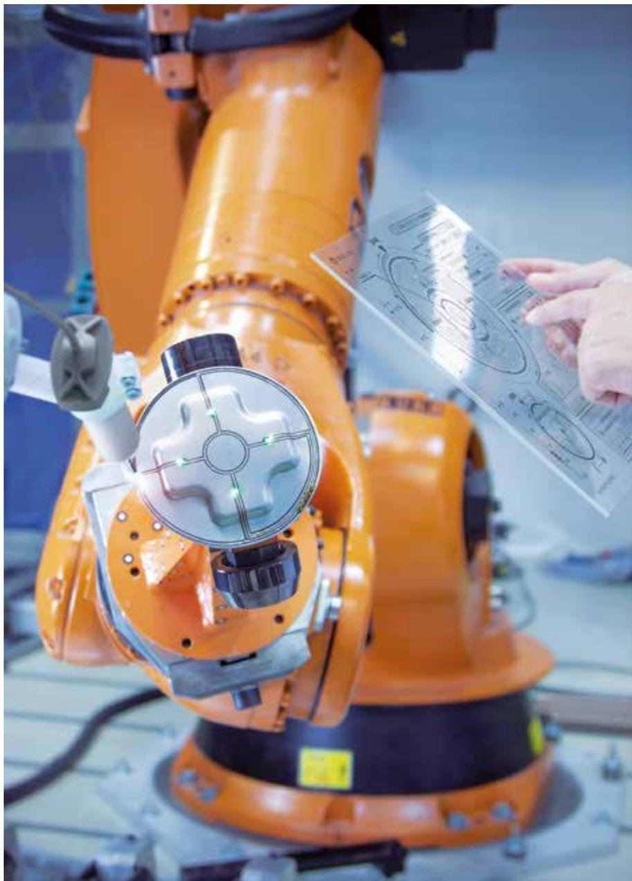
Digital gesteuerter 2,5 D-Funktionsdruck auf gebogenem Bauteilkörper
