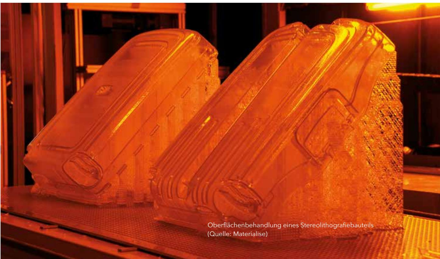
Oberflächenbehandlung eines Stereolithografiebauteils
